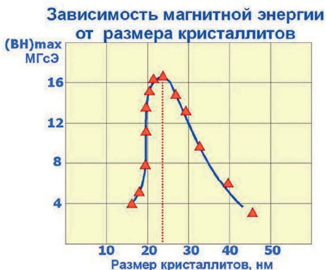
Рис. 2. Зависимость магнитной энергии от размера кристаллитов
